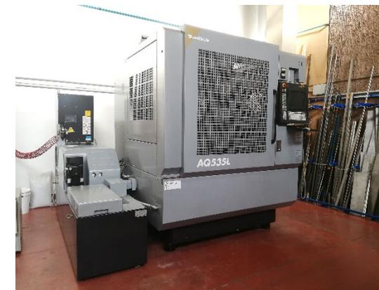
Elettroerosione a filo SODICK AQ535L
