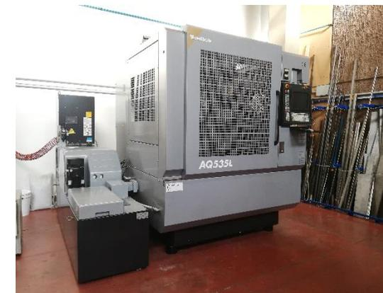
Elettroerosione a filo SODICK AQ535L
